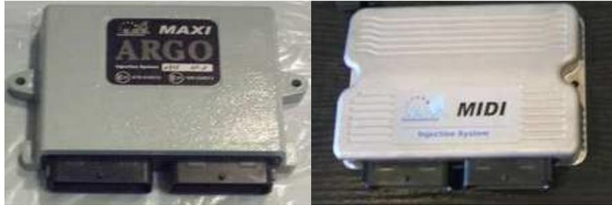
Установить подальше от источников электромагнитного излучения (бобина, генератор, высоковольтные провода, коммутатор, блок ABS и т.д.), теплового излучения. Хорошо закрепить разъемом вниз на кузове автомобиля в месте не доступном для прямого попадания влаги.
