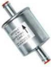
С целью сохранения чистоты в полостях Магистрали форсунок, был установлен фильтр тонкой очистки. При подсоединении смотреть на направление подключения указанном на фильтре. Его необходимо менять каждые 10 000-15000 км.
