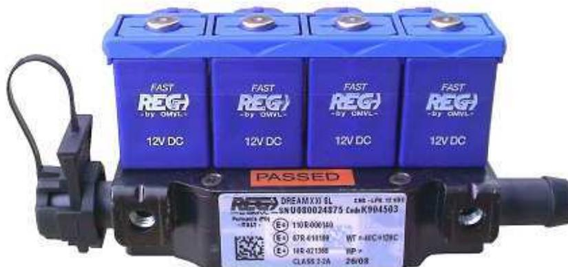
Устройство, управляемое с ЭБУ газа, предназначенное для подачи необходимого количества топлива в каждый цилиндр в отдельности.
