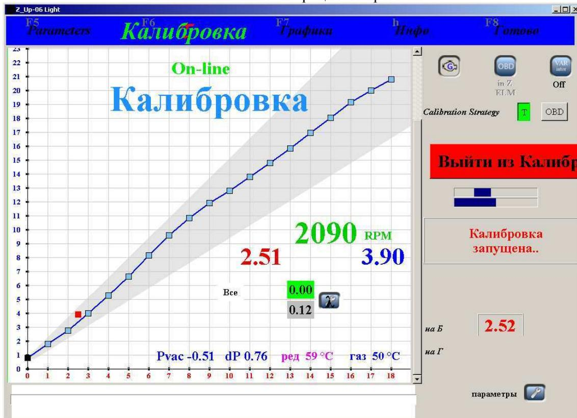
Окно предназначено для калибровки ЭБУ при работе на газе
