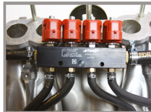
УСТАНОВЛЕННЫЕ ГАЗОВЫЕ ФОРСУНКИ
