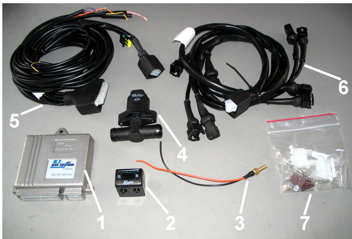
Rys.1. Fotografia systemu „DETEC Super” DTS01: 1 – sterownik DTBS01, 2 – centralka DTC01, 3 – czujnik temperatury reduktora, 4 - zawór gazowy z silnikiem krokowym 7217R063, 4 - wiązka przewodów elektrycznych DTSW01, 6 – przewody elektryczne do podłączenia emulatora wtryskiwaczy, 7 – bezpieczniki samochodowe wraz z oprawkami
