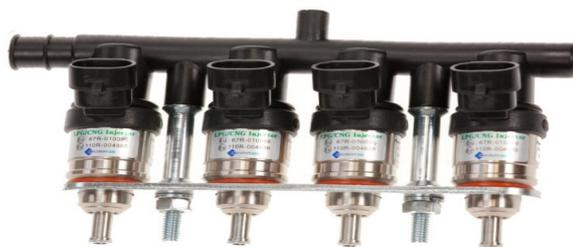
Газовые инжекторы подбираются по производительности таким образом, чтобы во всех режимах работы двигателя время бензинового впрыска на газе было равно времени бензинового впрыска на бензине. Данные, приведенные в таблицах ниже, помогут сделать правильный выбор.
