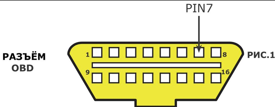
Подключить провод ЗЕЛЁНОГО цвета с сигналом исходящим с PIN номер 7 разъёма OBD находящимся в автомобиле.
