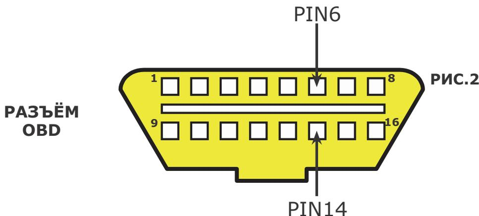
Подключить провод ЖЁЛТО-ЗЕЛЁНЫЙ с сигналом исходящим с PIN 6 разъёма OBD находящимся в автомобиле, а провод ЖЁЛТО-СЕРЫЙ с PIN 14 этого разъёма.
