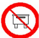
Когда газовая система "сжигает" предохранитель, система автоматически переключается на работу на бензине. Не рекомендуется заменять предохранитель с высшим значением величины силы тока потому, что это может привести к необратимым повреждениям.
