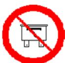
Проинформируйте потребителя, что в случае сгорания плавкого предохранителя газовой системы, соединение приборов, к которым он подключен, будет восстановлено. Настоятельно не рекомендуется устанавливать плавкий предохранитель с более высоким номиналом, поскольку это может привести к непоправимому ущербу.
