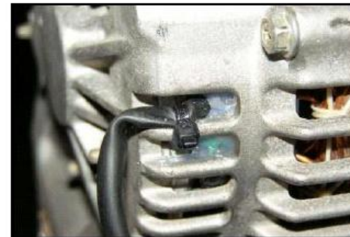
Pobranie sygnału z alternatora – zabezpieczenie przed drganiami.
