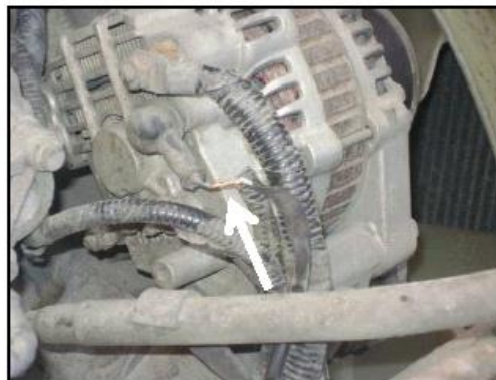
Pobranie sygnału prędkości obrotowej z alternatora.
