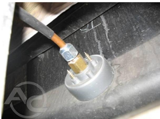
Рис. 1.3.3 Внешний вид заправочного клапана с внутренней стороны
