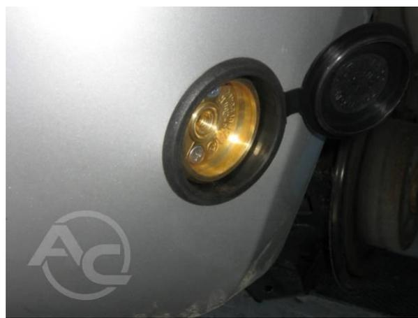
Рис. 1.3.4 Внешний вид заправочного клапана с внешней стороны
