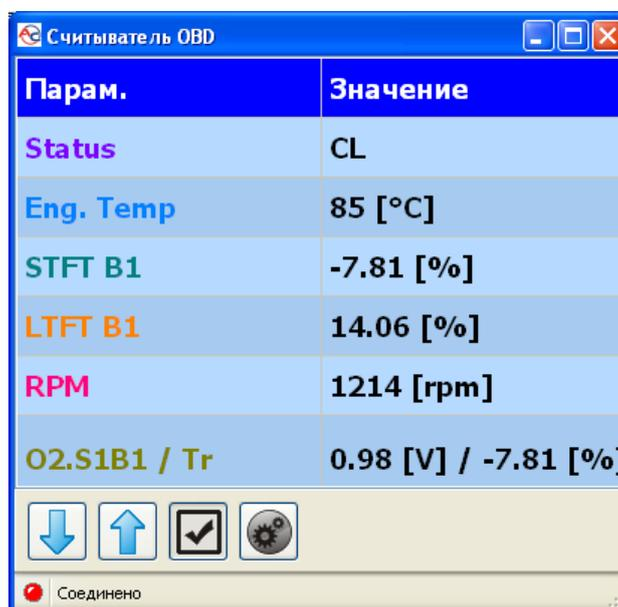
Рис. 2.1.30 Окно „Считыватель OBD”.
