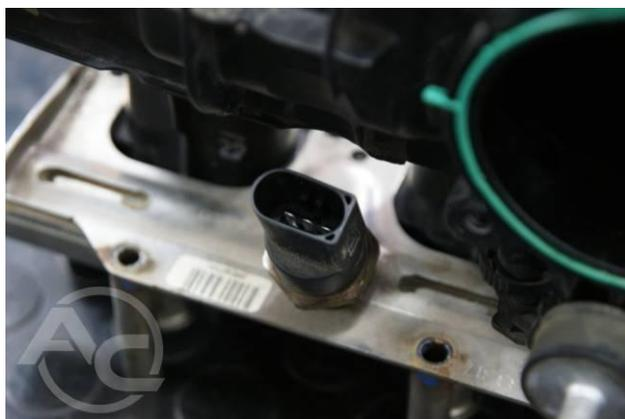
Рис. 1.3.36 Датчик давления топливной планки
