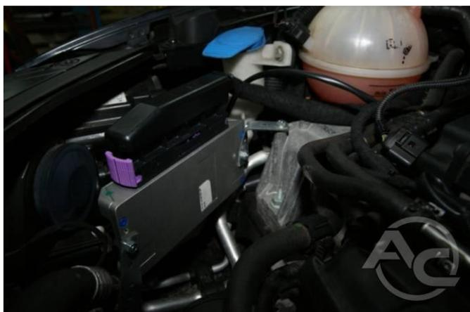
Рис. 1.3.31 Внешний вид установленного контроллера
