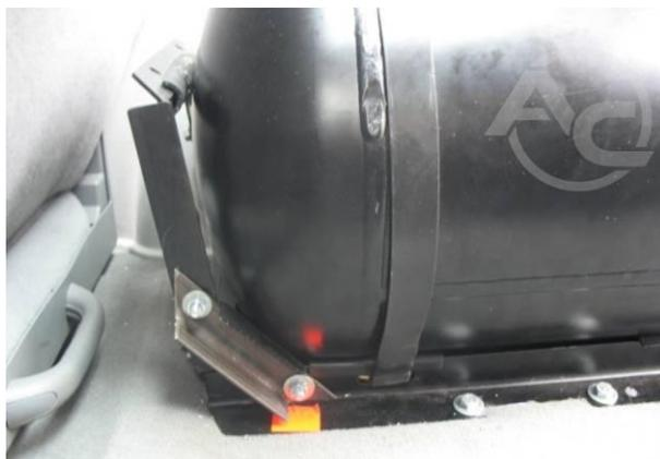
Рис. 1.3.9 При установке цилиндрических баков вдоль транспортного средства необходимо предусмотреть элемент, ограничивающий движение бака по направлению к передней части транспортного средства.
