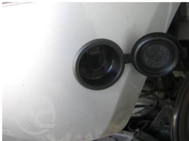
Рис. 1.3.2 Монтаж крышки заправочного клапана
