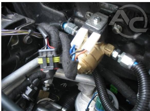
Рис. 1.3.23 Соединение проводки с электроклапаном.
