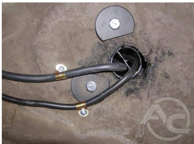
**Рис. 1.3.20** Прохождение газопроводов через шасси
