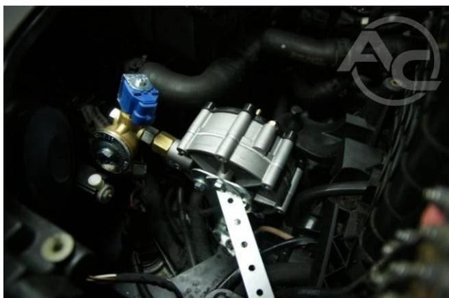
Рис. 1.3.25 Крепление редуктора
