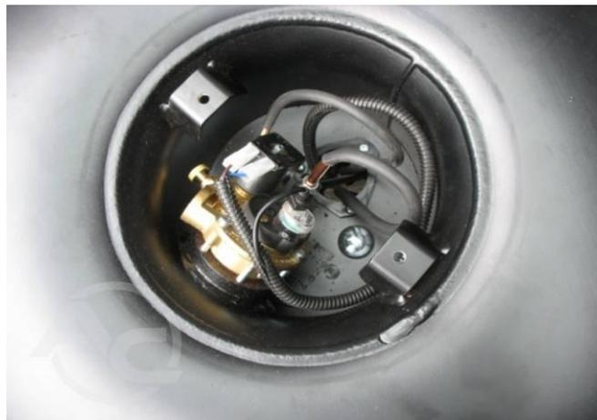
**Рис. 1.3.11** Внешний вид мультиклапана
