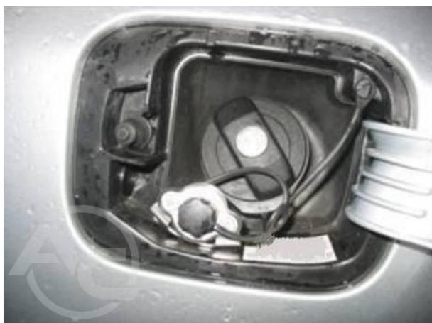
Рис. 1.3.5 Заправочный клапан в углублении заливного отверстия бензина
