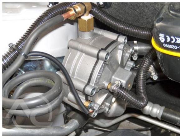
Рис. 1.3.26 Подключение редуктора
