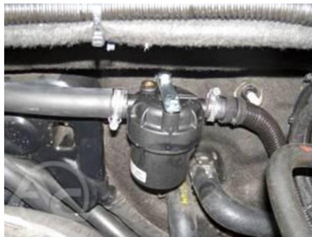
Рис. 1.3.28 Фильтр газовой фазы LPG
