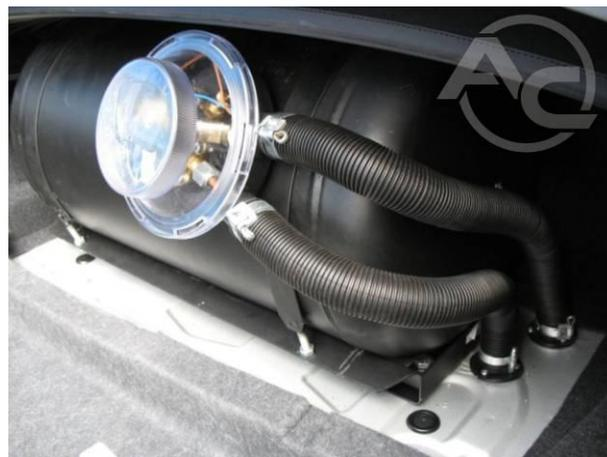
Рис. 1.3.15 Общий вид газонепроницаемых шлангов
