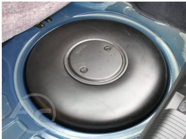
**Рис. 1.3.10** Внешний вид установленного бака
