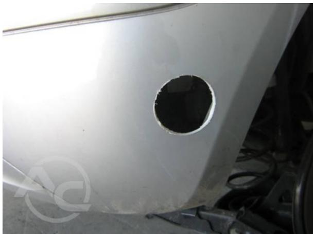
Рис. 1.3.1 Изготовление отверстия в бампере
