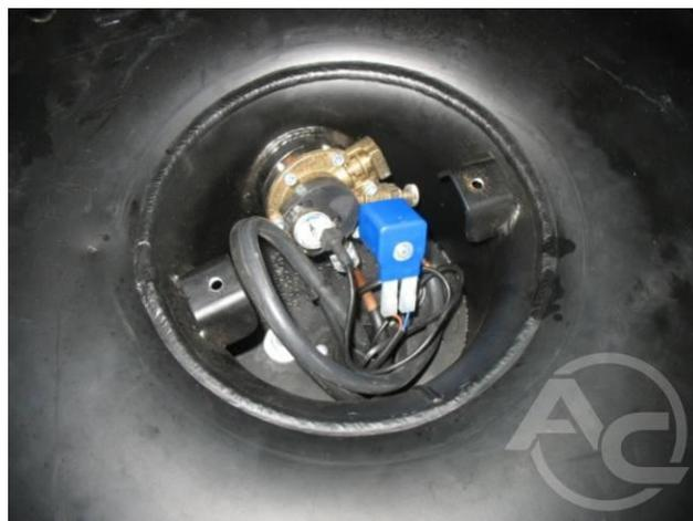
**Рис. 1.3.19** Внешний вид подключенного мультиклапана
