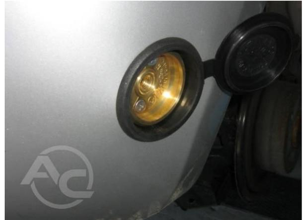
Картина 3. Монтаж наполняющего клапана в легковом автомобиле
