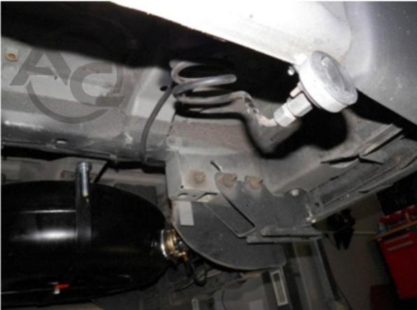
Картина 2. Монтаж наполняющего клапана в грузовом автомобиле
