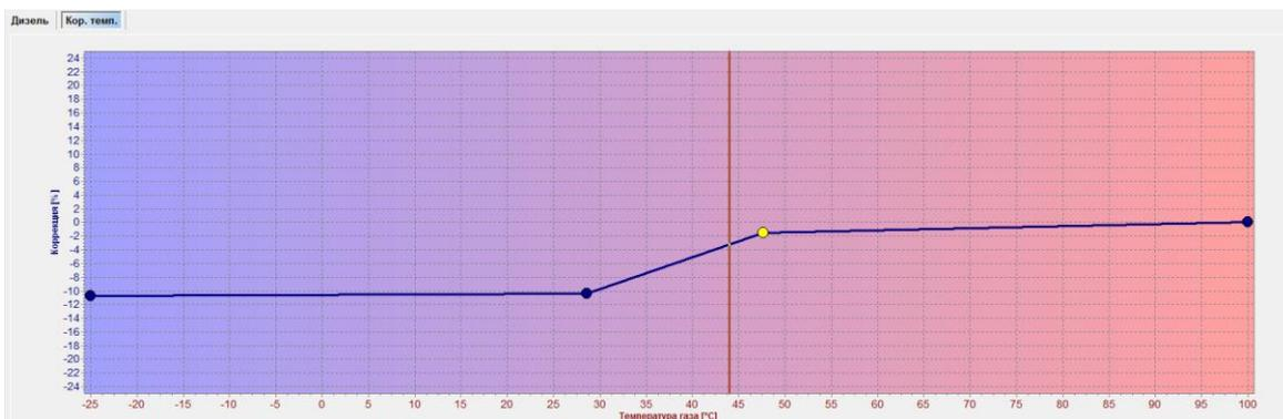
Рисунок 22 Корректировка в зависимости от температуры газа
