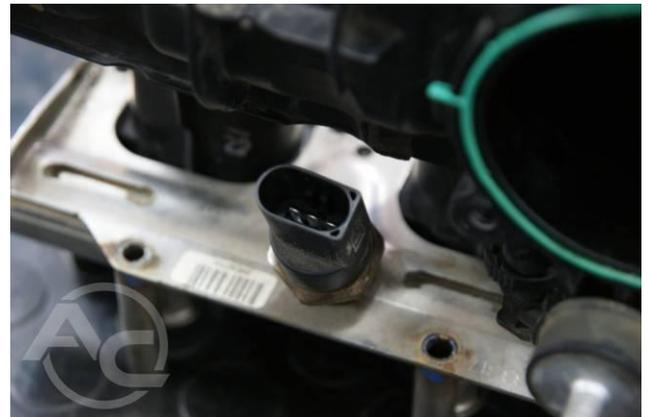
Изображение 6. Датчик давления топливной планки
