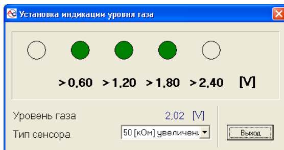
Рис. 14 Установка порогов светодиодов
