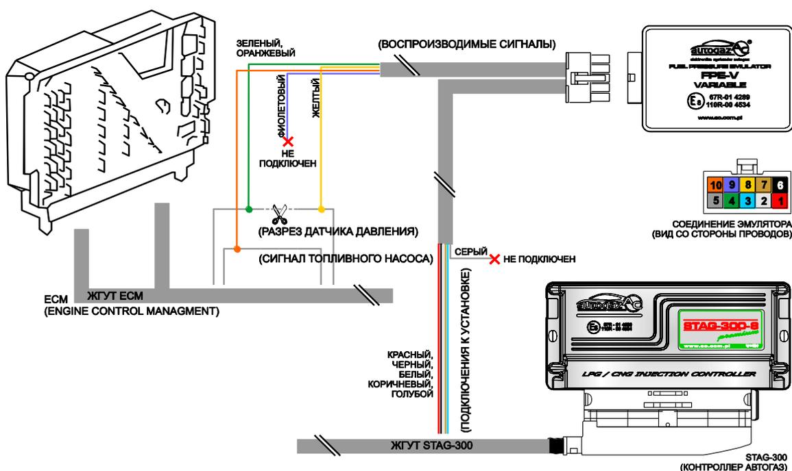
Рекомендуется «врезаться» в жгут контроллера серии STAG-300 и разделить сигнал с жгута системы подачи бензина - модуля ECM (Engine Control Management). «Врезаться» в проводку контроллера серии STAG-300 следует согласно таблице соединений.
